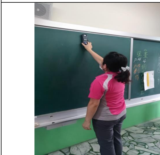
說明：教室黑板上方照度檢測
