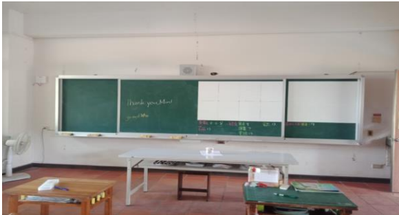
改善前：三至六年級因更換新式黑板與教室 投影設備黑板上方無照明設備所以 黑板部分光線明顯不足。
