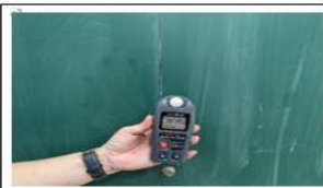
照片說明：黑板照度
