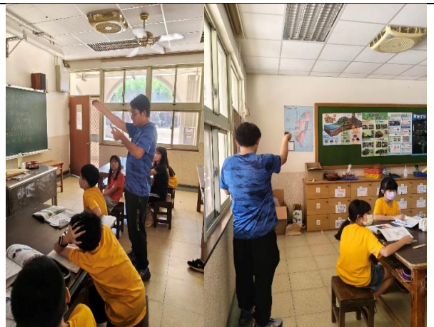
廠商進行教室內自然光照度測量。
