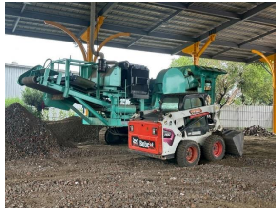
說明：校園光電球場施作, 級配層的部分利用學校舊磚現場請破碎機現場破碎用於球場底層, 達到永續回收再利用。
